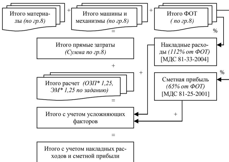
Рисунок 1. – Схема формирования сметной стоимости СМР по видам работ
